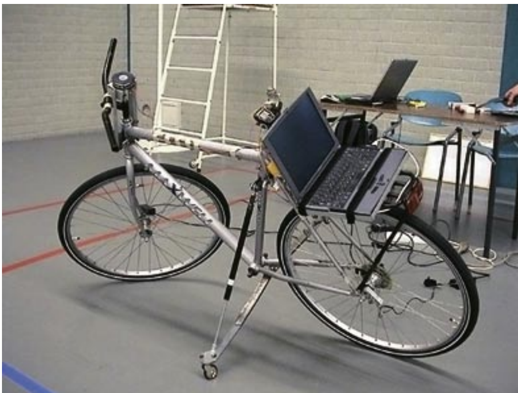
De testfiets zoals deze is gebruikt om het model te testen. De laptop achterop verzamelt de gegevens, die nodig zijn om het model te kunnen verifiëren. De zijwieltsjes zorgen ervoor dat de fiets niet echt omvalt en daardoor de apparatuur beschadigd
